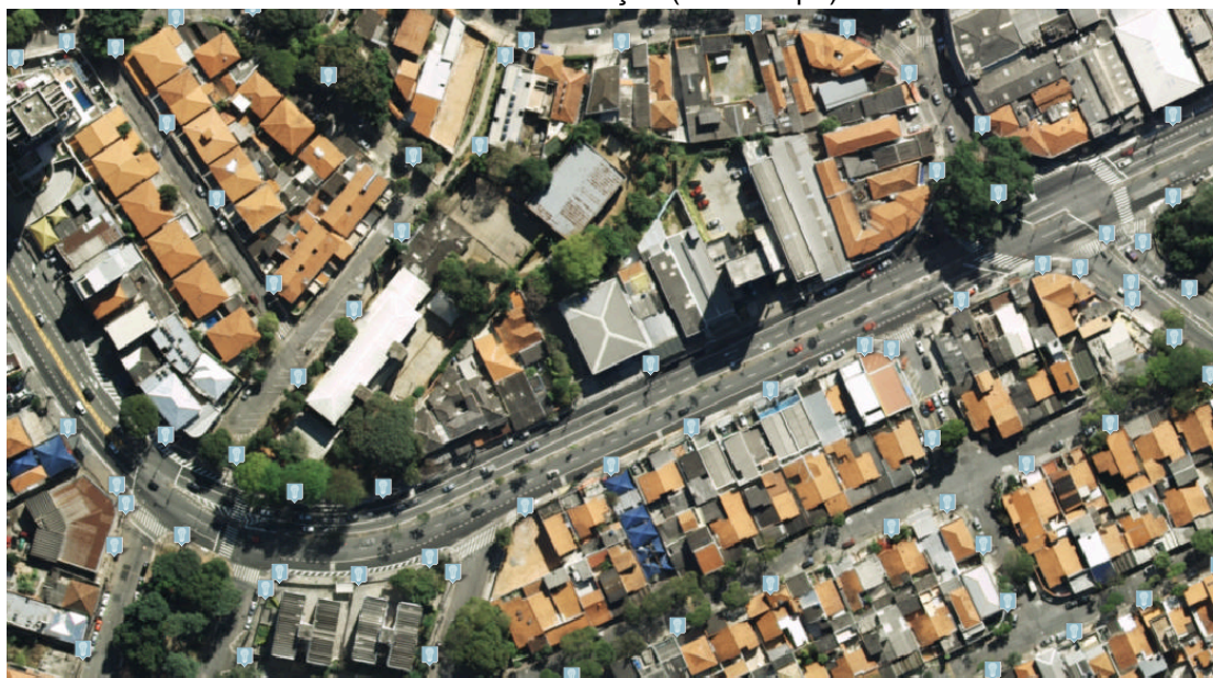
Figura Nº 7 Pontos de iluminação (GeoSampa)
